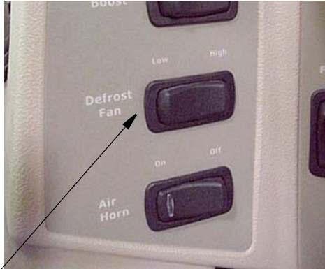
Defrost Fan Switch
